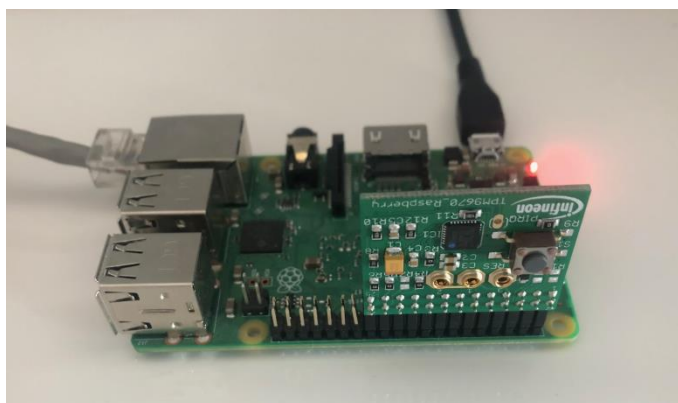
Figura 11. Modulul OPTIGA TPM SLB6970 conectat pe pinii plăcii de dezvoltare Raspberry Pi 3
