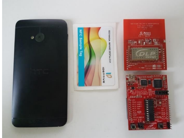
Figura 3. Dispozitivele cu capacități NFC folosite: telefon mobil, card NFC și kit embedded de dezvoltare
