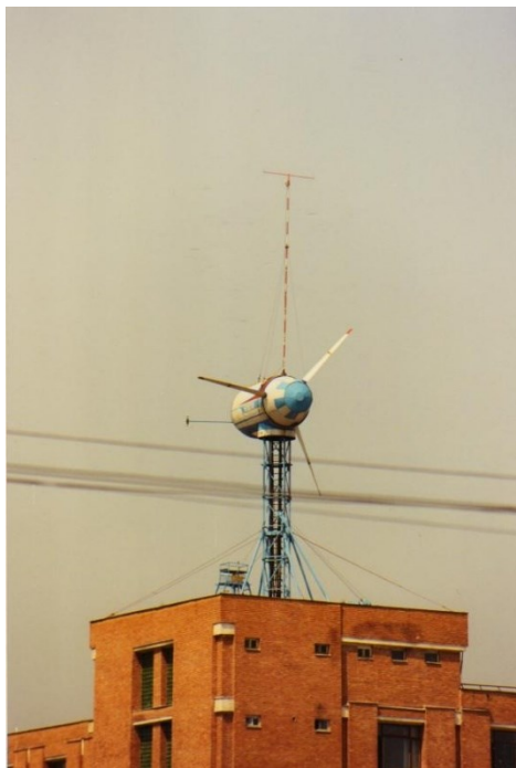
Agregatul AEROTIM L1, cu frecvență constantă la turație variabilă, realizat la Universitatea Politehnica din Timișoara
